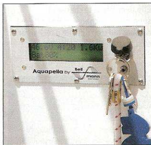
Des informations complètes. L'écran affiche tension des batteries, autonomie, consommation et charge.
