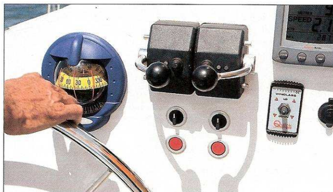
La simplicité. Une brève pression sur l'interrupteur rouge suffit pour lancer le générateur. Toute la puissance des moteurs électriques est alors disponible, pilotée par les commandes électriques.
