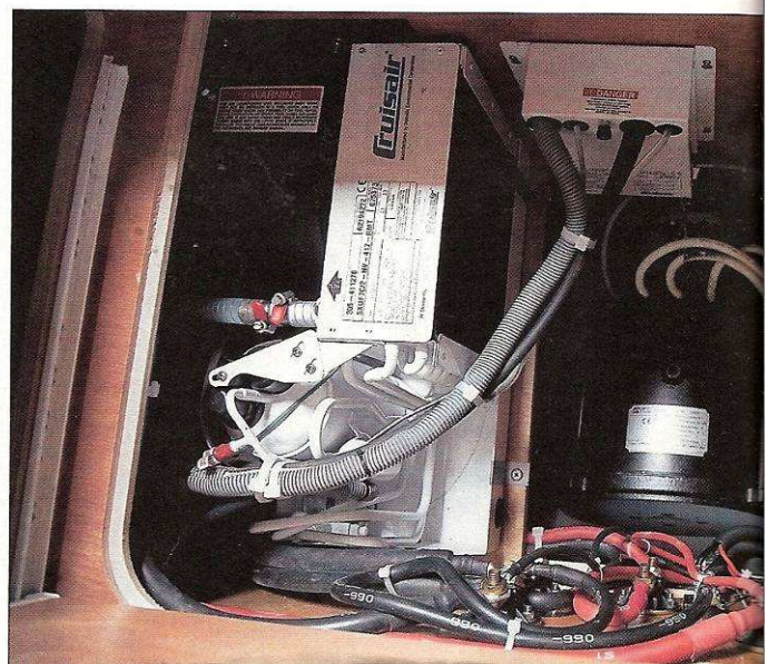
Générateur. Caché dans un coffre du cockpit, le groupe électrogène recharge les parcs batteries.
