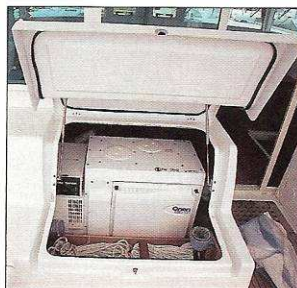
Générateur. Caché dans un coffre du cockpit, le groupe électrogène recharge les parcs batteries.
